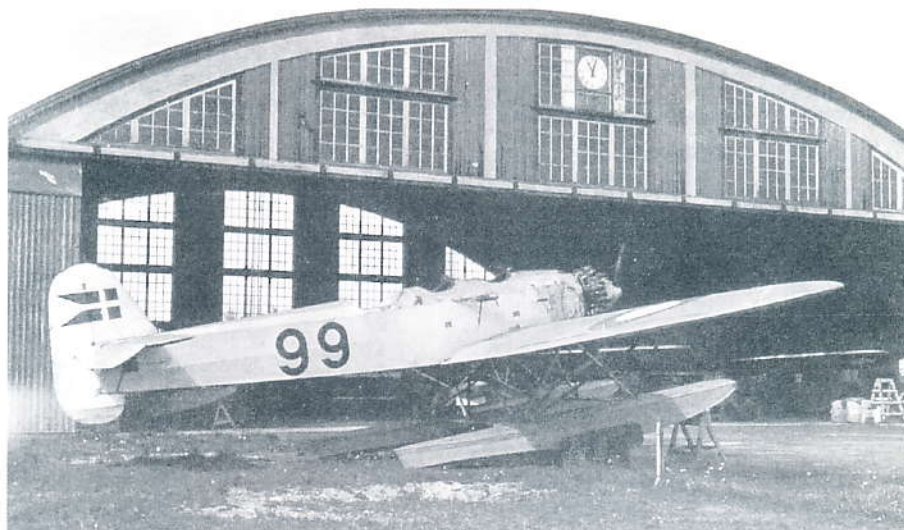
Marinens veltjente vandflyver Heinkel He 8, som nåede at være i brug fra 1928 til 1940, tjente primært som rekognosceringsfly, men kunne også bestykses med to 8 mm maskingeværer samt 12 et punds bomber. Flyet var udstyret med en 460 Hk stor Armstrong-Siddeley Jaguar stjernemotor som gav den en tophastighed på 210 Km/h, og en maxhøjde på 5600 m. I fuldt lastet stand vejede den 2650 kg. De første seks Heinkel He 8 blev leveret fra Heinkel Werke i Rostock, og de næste 16 (He. 8 H.M.II) blev bygget på orlogsværftet - de sidste så sent som i 1938.
